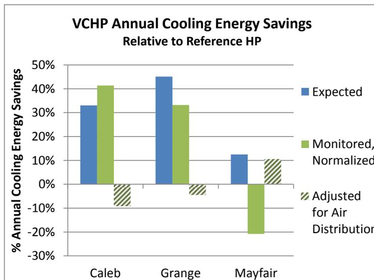
FIGURE 28. VCHP COOLING SAVINGS ADJUSTED FOR AIR DISTRIBUTION ENERGY IMPACTS
