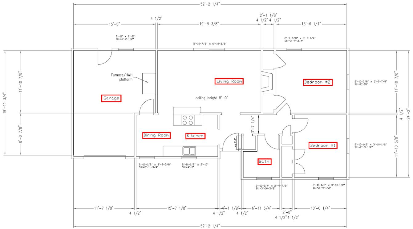
FIGURE 18. GRANGE FLOOR PLAN
